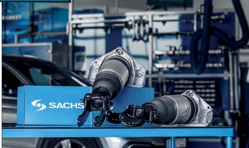
плекте всех необходимых монтажных деталей, включая верхнее крепление. Стойки совместимы с электронными системами управления и поддерживают функции автоматического выравнивания и адаптивного демпфирования.
